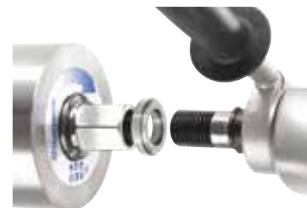
4 Snelontgrendeling om de boor gemakkelijk van de boormotor los te maken
