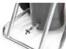
17 Aansluiting waterslang voor PP 455 E
