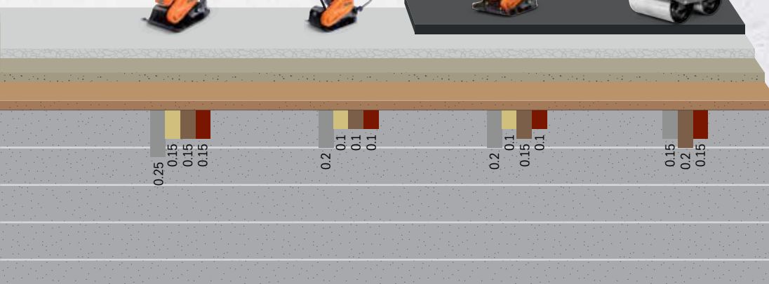
Maximale diepte bij 4x overgaan / LP rollers bij 8x overgaan.
